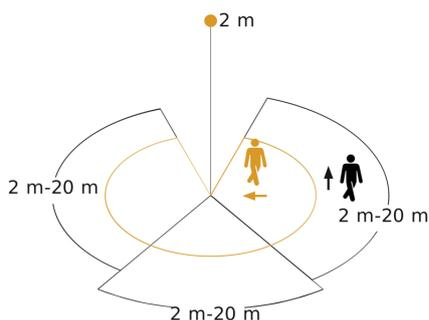
Possibile altezza di montaggio: 2,00 m – 5,00 m
